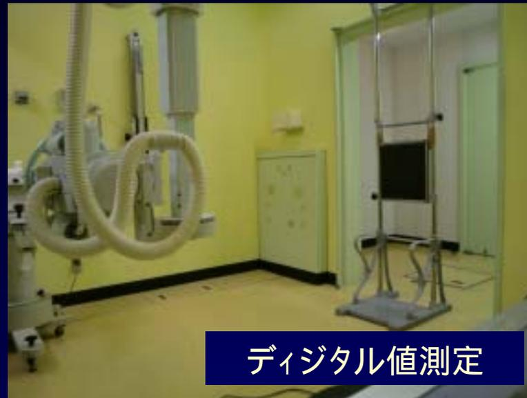
(方法) 感度測定と同じ幾何学的配置において,撮影線量を変化させ,IP入射線量毎にS値を求め線形であるかの確認を行う.
